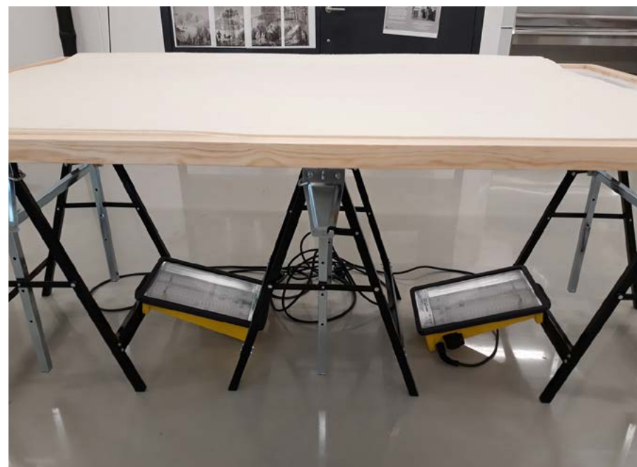
Valopöytä rakennettiin muovilevyistä ja rakennusvaloista. Levyjä tukevoittaa purettava puukehikko. Kuva Sara Théodore, 2019, Museovirasto.
