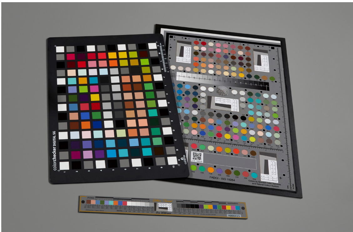
Targetteja: ColorChecker Digital SG (vas.), FADGI 19264 (oik.) ja ISA Object level target (alla). Kuva: Matti Kilponen, Museovirasto, CC BY 4.0
