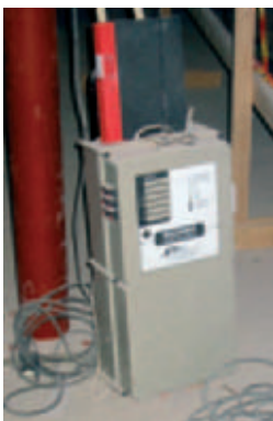
Analysoivan systeemin (MADAMM) siirrettävä keskusyksikkö työmaalla.
