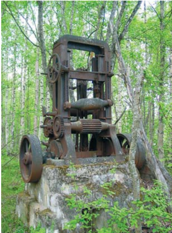
Jyhkeästi perustetut työkoneet ja voimansiirtolaitteet ovat usein säilyneet kevyitä tuotantorakennuksia pitempään. Vuoden 1913 rakennussuunnitelmassa näkyvä sahanraami osoittaa maastossa yhden monista Rovaniemen Sinetän kylän teollisuushistoriallisista paikoista. Kuva Timo Kantonen, Museovirasto. Piirustus Paavo Heikkilän yksityiskokoelmasta.
