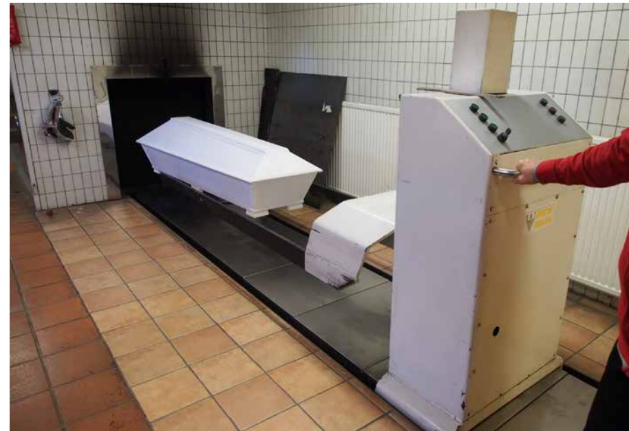
Krematoriossa arkku siirretään polttouuniin arkkukuljettimen avulla. Lahden Levon siunauskappelin krematorio.
