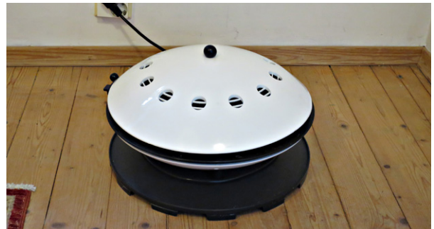
Höyrystävä ilmankostutin, joka toimii sähköllä. Kaikki ilmankostuttimet vaativat säännöllistä puhdistamista.
