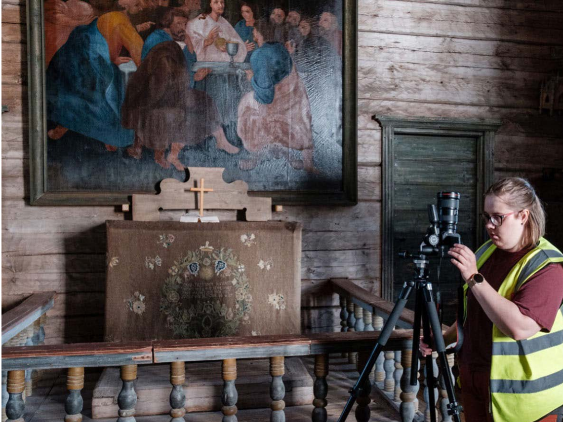
Mittaaja valmistelee järjestelmäkameraa Petäjäveden vanhan kirkon fotogrammetrista dokumentointia varten. Kuva: Matti Kilponen, Museovirasto.
