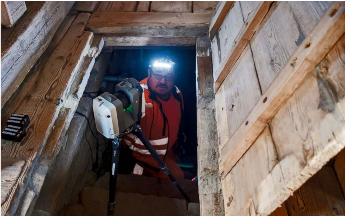
Laserkeilaaja laskeutuu kevyen, pienempiin etäisyyksiin ja ahtaisiin tiloihin soveltuvan laserkeilaimen kanssa mittamaan Petäjäveden vanhan kirkon alapohjaa. Kuva: Matti Kilponen, Museovirasto.
