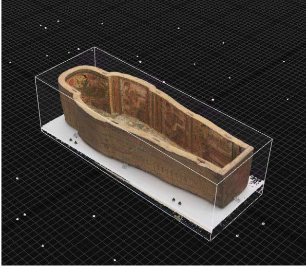
Egyptiläisen sarkofagin (KM14560:660) fotogrammetrinen malli Reality Capture-ohjelmassa. Valkoiset pisteet merkkävat mallinnuksen pohjana olevien valokuvien ottamispaikkoja.
