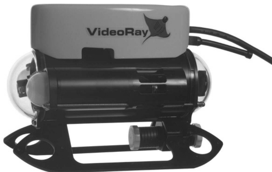
Kuva 1.9: Vedenalainen robottivideokamera Video Ray Pro.
