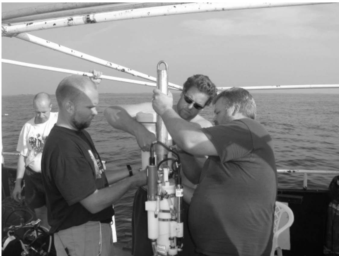
Kuva 1.7: CTD/ADCP-ympäristötiedonkeruulaitetta kootaan veteenlaskua varten. Vasemmalta Matias Laitinen, Kenneth Lindström, Juha Flinkman. Kuva: Ulla Klemelä, Museovirasto.
