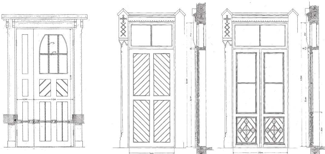
Rautatierakennusten ikkuna- ja ulko-ovityyppejä
