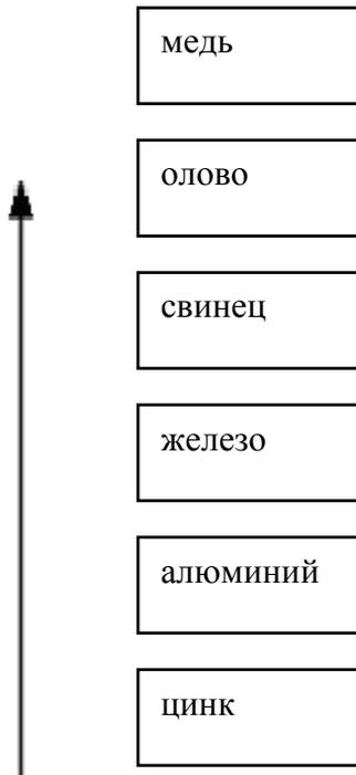
Расположение часто встречающихся металлов по степени их ценности. Если на кровлю устанавливают металлические детали, то во избежание появления вредной двойной коррозии нужно, чтобы их металл был тот же, что и металл кровли. На рисунке надписи (снизу - вверх): цинк, алюминий, железо, свинец, олово, медь.
