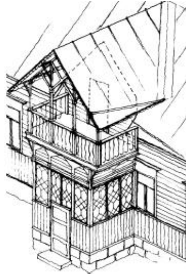
Нижняя часть – закрытое крыльцо, верхняя – балкон
