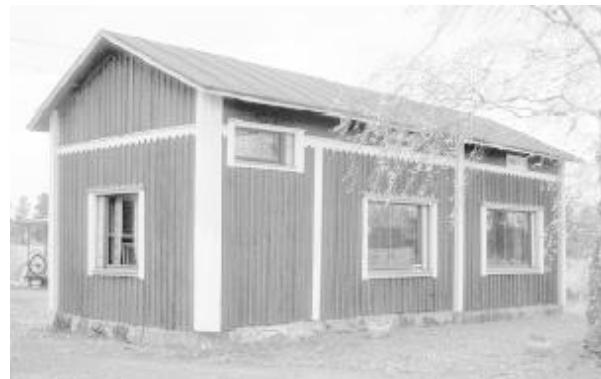
Современная деталь не обязательно подходит к старому дому. Здесь показательный пример переделанных окон, которые портят внешний вид дома. Также и новые материалы могут вызывать технические проблемы, когда их необдуманно объединяют с традиционными материалами. Например, полиэтиленовая пленка и бетонные плиты в деревянном доме.
